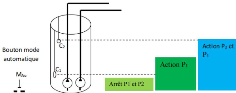
**Figure 3.3 :** Schéma du réservoir équipé des capteurs de niveau et deux pompes émergées
