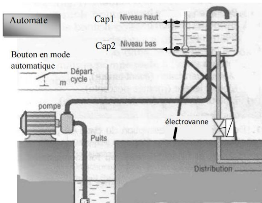
**Figure 3.1** : Station de pompage équipée du système automatique
