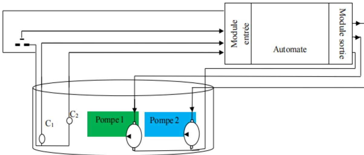
**Figure 3.4** : Schéma du câblage électrique avec l'automate
