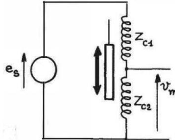
Capteur de déplacement fonctionnant en push pull.
