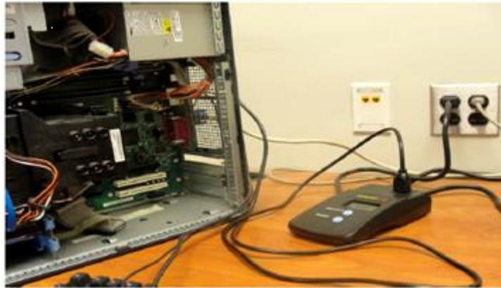
**Fig.IV.2** Wattmètre électronique mesurant la puissance d'entrée AC d'un Ordinateurs de Bureau.
