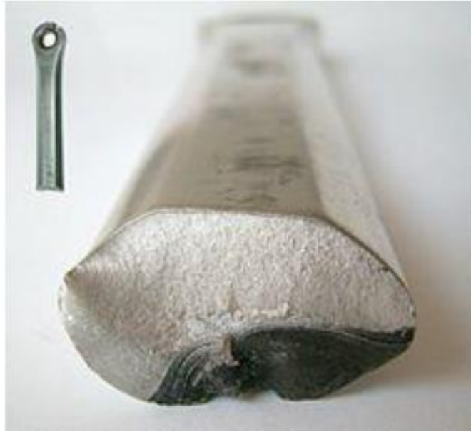
Figure 2-24: Faciès de rupture de fatigue (manivelle de pédalier de vélo) : On distingue les lignes de progression de fissures en bas à droite (zone sombre), et la zone d'arrachement (zone claire)
