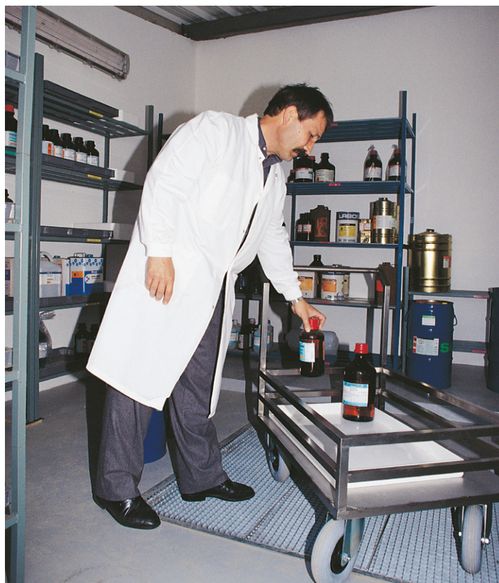
Intérieur d'un stockage central avec des bacs de rétention sur les étagères, une rétention centrale, un chariot de maintenance avec bac de rétention.
