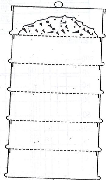
$$\% \text{Refus} = \frac{\text{Poids\_refus\_cumulé}}{\text{Poids\_echantillon}} \times 100$$
