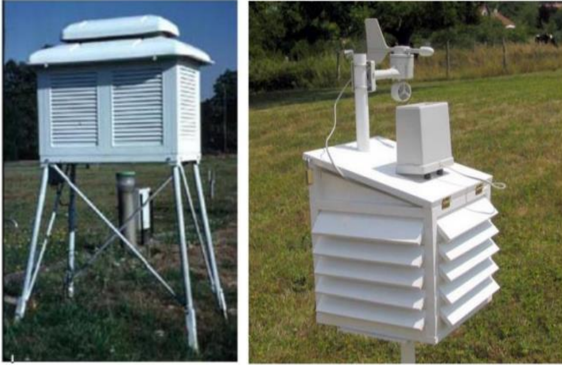
Fig n° 1 : Photos d'abris météorologiques.
