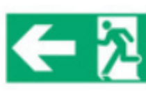
Direction d'une sortie de secours
