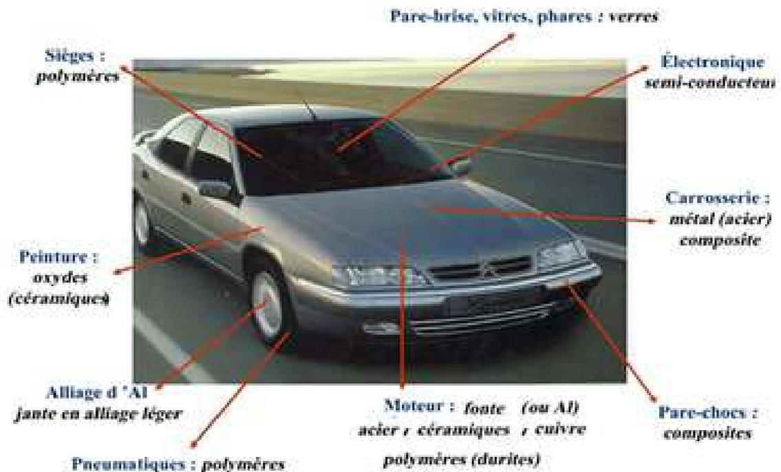
Figure 1.8 : différents matériaux dans la fabrication d'une voiture.
