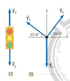
الحل: نرسم رسما تخطيطيا للقوى المؤثرة على إشارة المرور، كما هو مبين في الشكل b، ومخطط الجسم-الحر diagram كما هو مبين في الشكل of the forces للعقدة التي تربط الاسلاك الثلاثة معاكما هو موضح بالشكل c. هذه العقدة للماه هي الجسم الملائم للاختيار، لأن كل القوى تؤثر على امتداد خطوط تمر عبر هذه العقدة.
